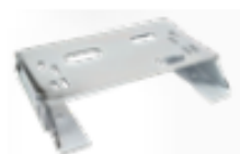
P-550CPMR Placa base con ajuste de altura desde un mínimo de 65 mm hasta un máximo de 94 mm
