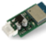
P-250T-WIFI Dispositivo para conexión WIFI de 2.4 GHz que permite el uso del smartphone para programar y controlar las unidades de control remotamente a través de TauApp. (P-500MASTER20T excluidos)
