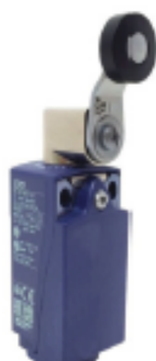
FINAL DE CARRERA INDUSTRIAL XCKP, formato estándar / 10 millones de ciclos IP67 / 250V 8A / contacto NO/NO
